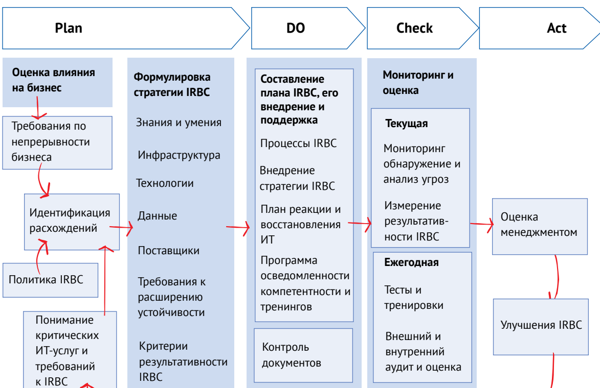
Рис 5. Структура и последовательность действий по построению ИТ, готового для обеспечения непрерывности бизнеса (IRBC).
